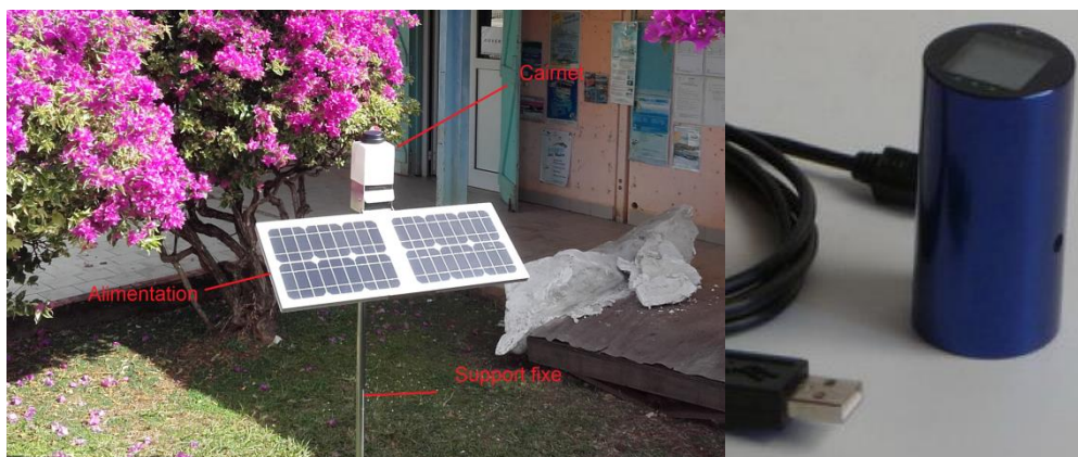
Figure 6: A gauche un dispositif Cairnet installé sur le site du front de mer dans la commune du Robert. A droite un Cairsens dédié à la mesure de l'H 2 S.
