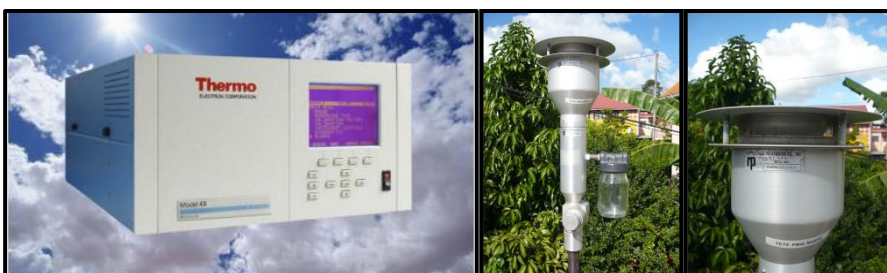
Figure 8: Dispositif permettant l'analyse automatique de l'H 2 S à la station fixe du Bourg au Robert. A gauche l'analyseur automatique et à droite la tête de prélèvement.
